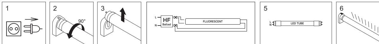
خطوات تبديل المصايبه الأنبوية التقليدية التي تعمل بوحدات التحكم الإلكترونية بمصايبه الليد الأنبوية:
