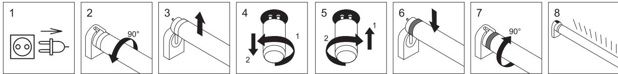
خطوات تبديل المصايبه الأنبوية التقليدية التي تعمل بوحدات التحكم الكهرومغناطيسية بمصايبه الليد الأنبوية:
