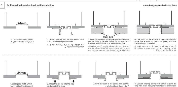
3. Lock the track to the ceiling with screws ۴. قفل المسار بالسقفبالبراغي.
