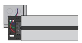
Thread the wire into the hole from the back and connect it to the corresponding terminal قم بادخال السلك في الفتحة من الخلف ثم قم بتوصيله بالطرف المقابل
