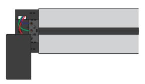
Thread the wire into the hole from the back and connect it to the corresponding terminal, then cover the fixed cover board property قم بادخال السلك في الفتحة من الخلف ثم قم بتوصيله بالطرف المقابل، ثم قم بتغطية لوحة الغطاء الثابت بشكل صحيح
